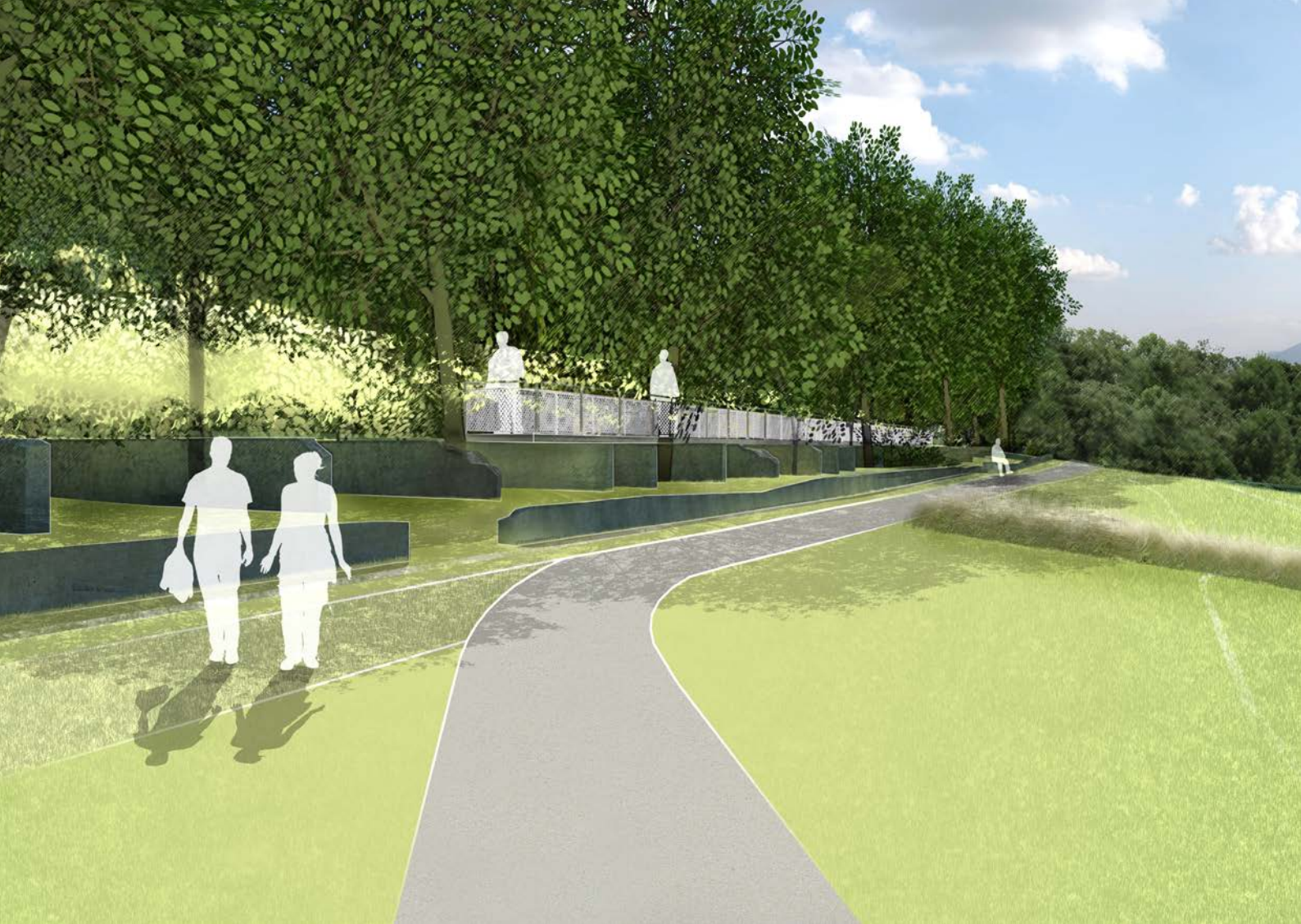
Darstellung des Steges aus Metallgitter, der über die Fundamentreste der ehemaligen „Ehrentribüne“ führt. Rodung des hangseitigen Bewuchses, um die Fundamente sichtbar zu machen.
